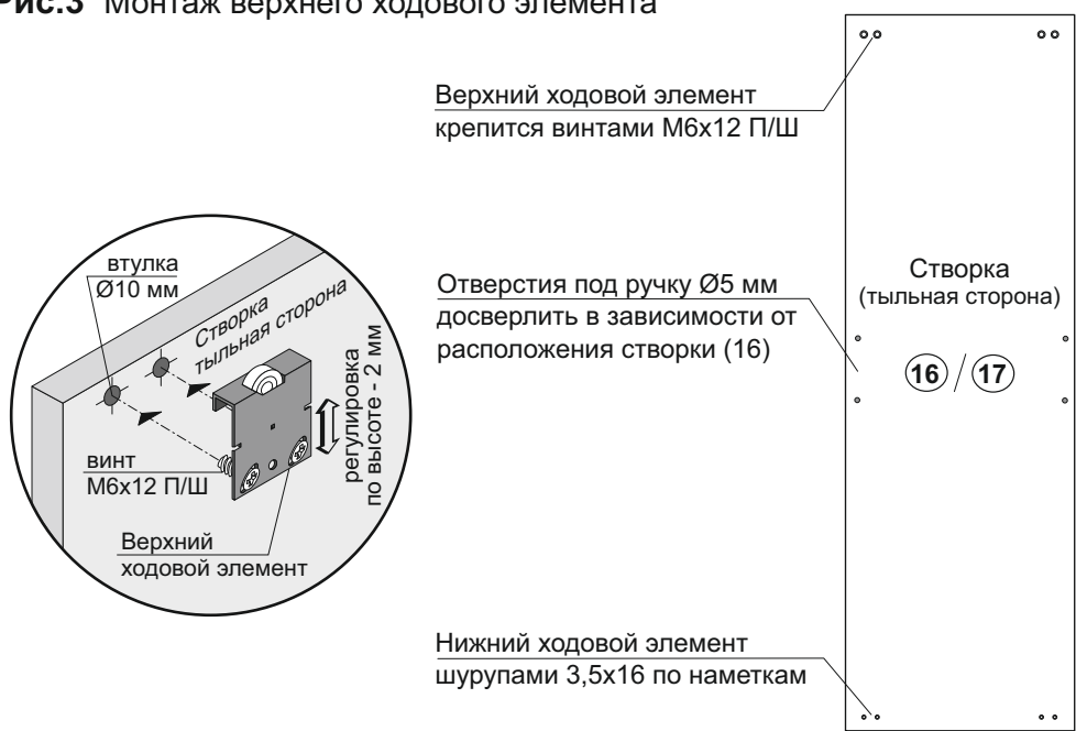
Рис.3 Монтаж верхнего ходового элемента
